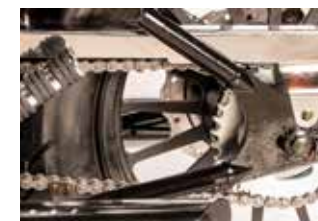
Cadena paso 530 con O'ring
