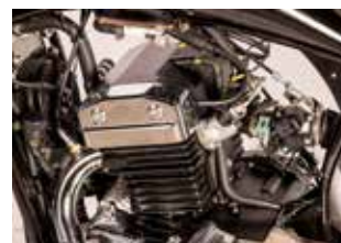
Motor de 396,4 CC Inyección electrónica
