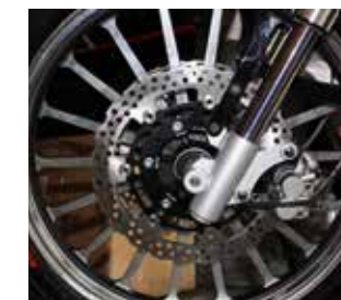
Doble disco de freno delantero de 300 mm Llantas de aluminio
