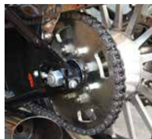
Cadena de transmisión paso 530 x 128 con O'ring
