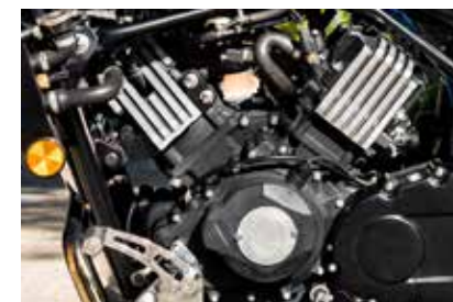
Motor 800 CC, 2 cilindros en V, 4 tiempos, 8 válvulas
