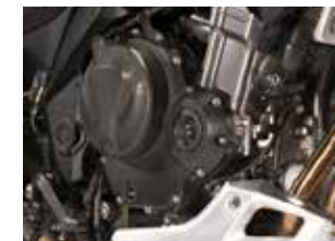
Motor Loncin Doble árbol de levas 8 válvulas
