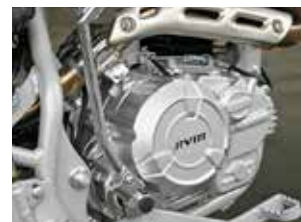
Motor monocilíndrico de 223 CC, refrigerado por aire
