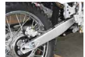
Freno trasero Simple disco hidráulico \phi 220 mm
