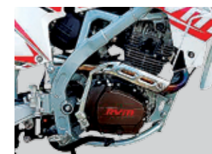
Motor monocilíndrico de 232,6 CC refrigerado por aire
